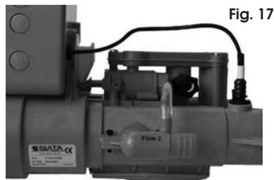
In fig. 17 è visibile l'installazione della sonda contaltri su una valvola V132 quando il cavo è montato nel box del controller.
